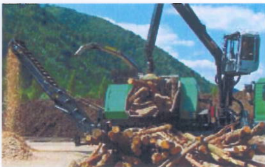
Lkw-betriebener Mobilhacker Chippo 5010 Cd mit verbessertem Kühlsystem eignet sich sowohl für Stammholz als auch Strauchmaterial. Foto: Komptech
