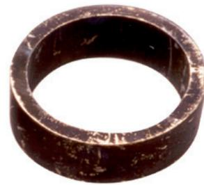
Gravemente danneggiato dall'attacco chimico dovuto all'incompatibilità di combinazioni di additivi diversi nei fluidi idraulici miscelati
