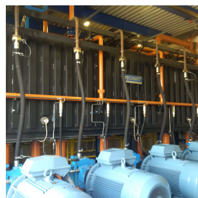
Centralina oleodinamica e pompe EATON a pistoni assiali
