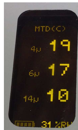
Immagine 1—Display dello strumento IOS con i risultati del test sul l'olio nuovo
